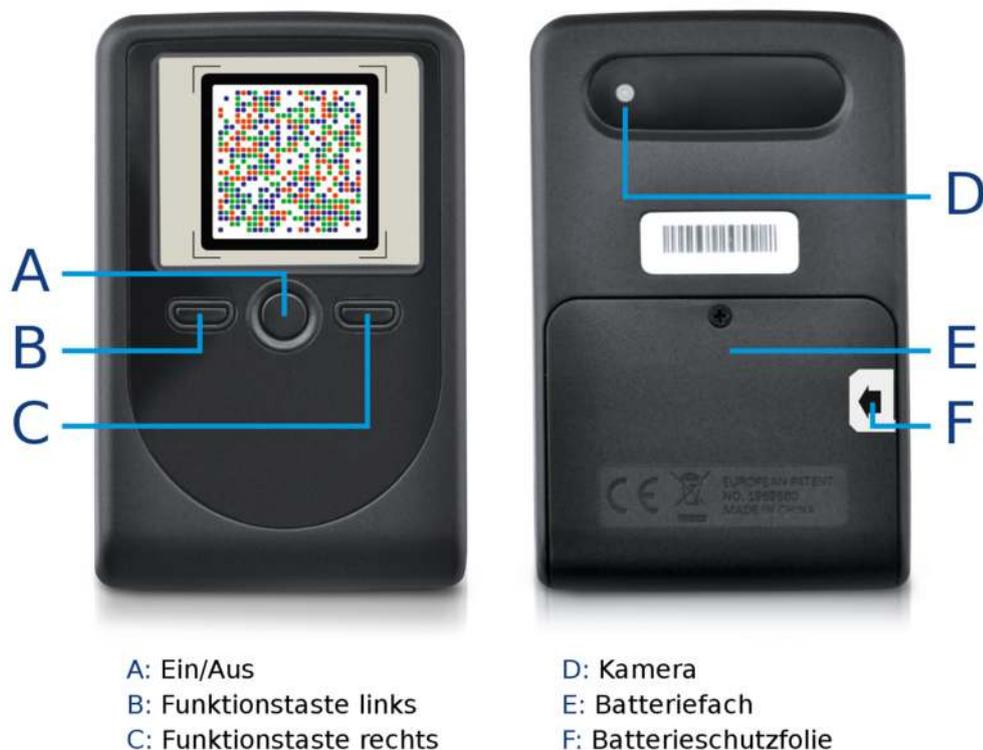
Mit dem mittleren runden Knopf schalten Sie das Gerät ein oder aus (mindestens zwei Sekunden gedrückt halten). Der linke und rechte Knopf dienen der Navigation durch die Menüs und Funktionen. Wird das Gerät nicht benutzt, wechselt die Anzeige nach 25 Sekunden in den Sparmodus (abgedunkelter Schirm) und schaltet es sich nach weiteren 15 Sekunden automatisch ab. Bei Betätigung einer der Funktionstasten im Sparmodus springt das Gerät wieder in den aktiven Modus zurück.
